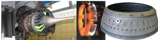
Tuyère, chambre et aubes de turbine en matériaux CMC
