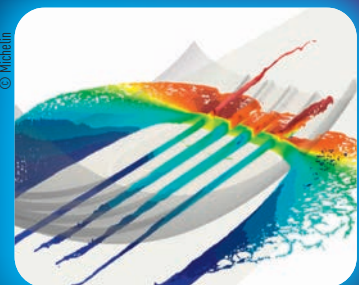
MICHELIN Simulation du phénomène d'hydroplanage par interaction fluide-structure d'un pneumatique usé roulant sur un film d'eau
