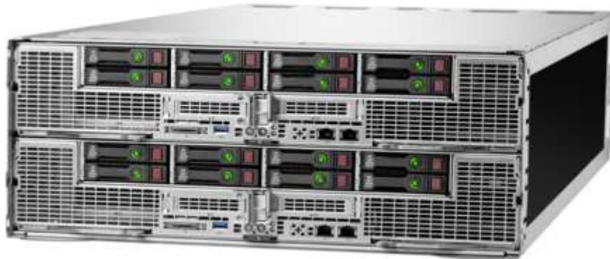
**L’Apollo 4520** offre un câblage interne pour le basculement, ainsi qu'une densité de disque massive de 23 disques à grand facteur de forme par serveur. Ce système est optimal pour les charges de travail telles que le système de fichiers parallèle Lustre et les espaces de stockage Microsoft.
