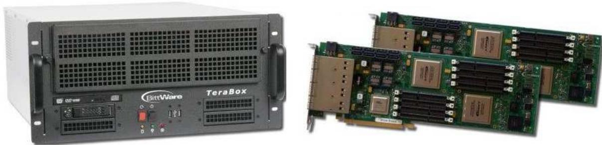
Pour moins d'un kW et dans un châssis 5U très compact, la **TERABOX** fournit jusqu'à 20 TFLOPs, 6,5 Tbits/s de bande passante mémoire et 1,28 Tbits/s de flux entrée/sorties.
