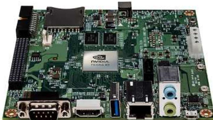
Le kit de développement NVIDIA Jetson TK1 est une plate-forme complète autour du processeur Tegra K1 destinée aux applications embarquées. Il vous permet de libérer la puissance de 192 cœurs CUDA pour développer des solutions autour de la vision par ordinateur, la robotique, la médecine, la sécurité, et l'automobile. Beaucoup de domaines intéressants dans l'informatique embarquée s'appuient sur la vision par ordinateur.
