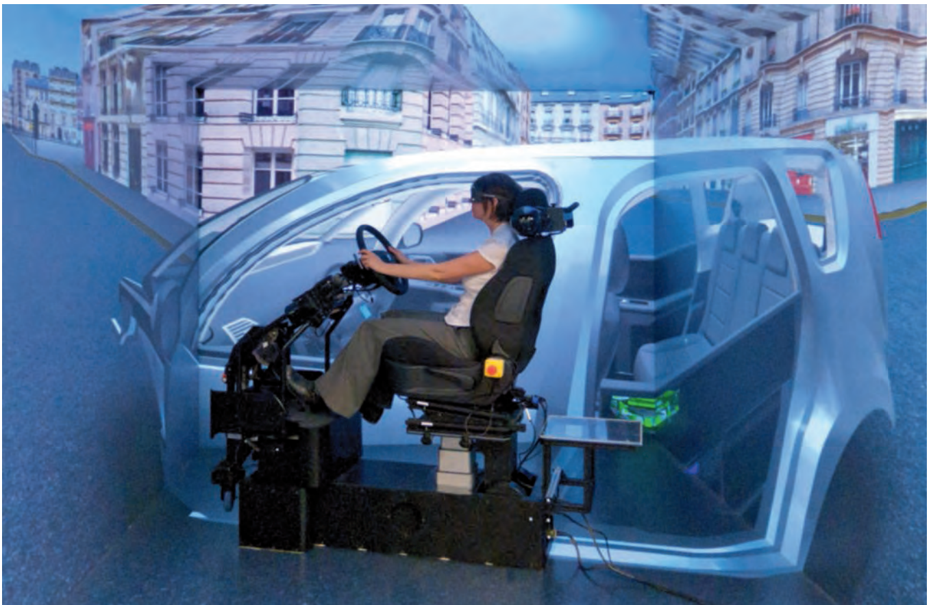
Dans sa salle de réalité virtuelle le Cave, PSA installe un dispositif à échelle réduite, l'Holobench, pour travailler sur la conduite en réalité augmentée (PSA).
