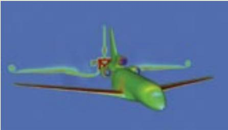
Le calcul numérique permet d'optimiser la forme des ailes (ici d'un Falcon). Au-dessus de l'aile, on observe en rouge la zone de basse pression, caractéristique de portance de l'avion. La visualisation du sillage permet d'analyser la traînée de l'avion. On note aussi la trace du tourbillon issu de l'extrémité de la voilure.
