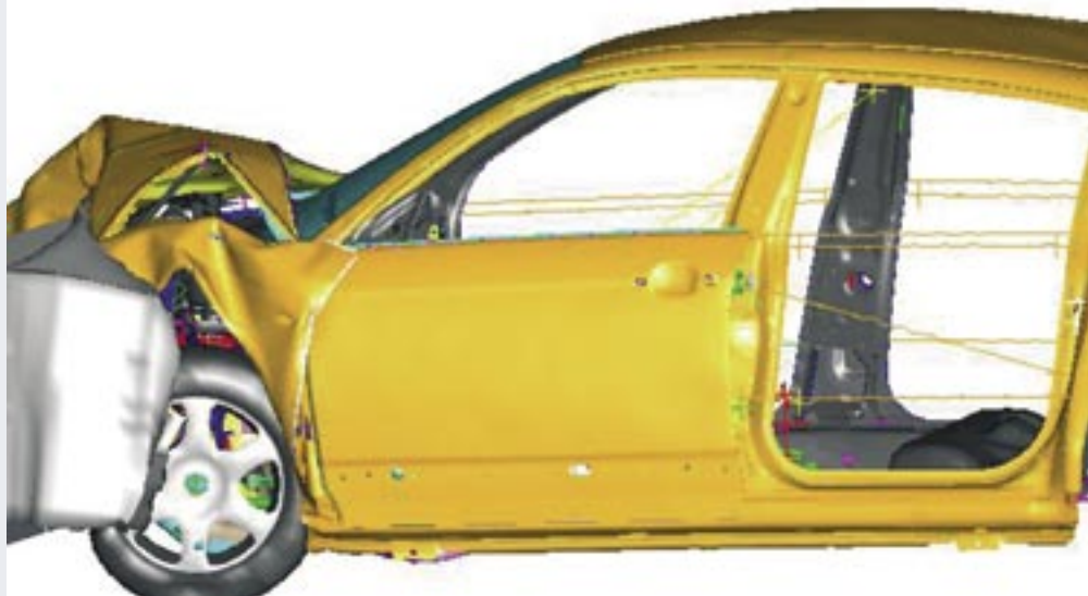
SIMULATION d'un choc frontal sur la Citroën C6. © PSA PEUGEOT/CITROËN
