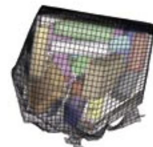
EXPLOSION NUMÉRIQUE dans le conteneur à bagages d'un avion commercial. © ONERA
