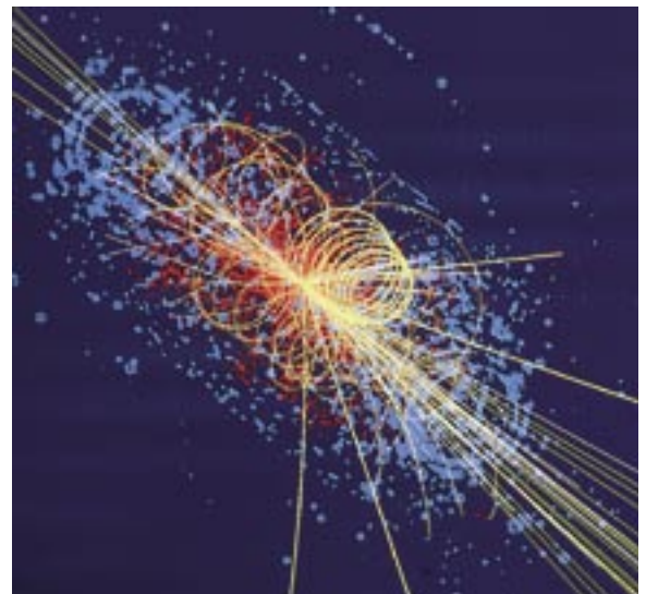
SIMULATION DE LA DÉSINTÉGRATION D'UN BOSON DE HIGGS dans l'un des détecteurs du collisionneur de particules du CERN, à Genève. Les traces représentent les particules produites lors de la collision de protons de très haute énergie. © CERN
