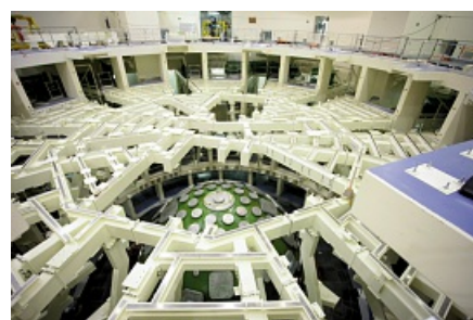
La sphère d'expériences vers laquelle convergent les 176 faisceaux laser.
