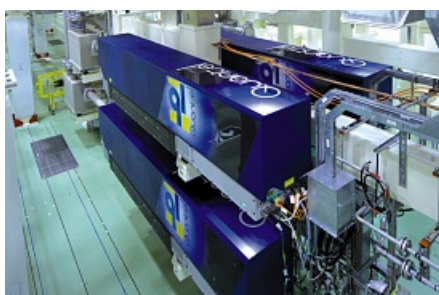
Une source laser de très faible énergie est pré-amplifiée à 1 joule.
