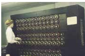
La Bombe électromécanique d'Alan Turing et Gordon Welchman
